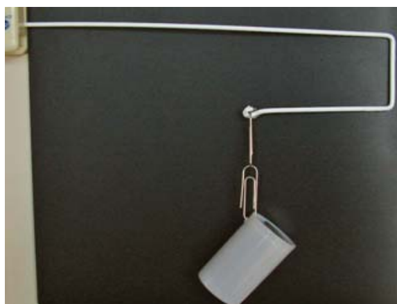
図5 針金でできたハンガー素材、フィルム容器、クリップ、100円玉を利用した曲げの弾性実験
