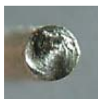
(b)クリップの破壊面
