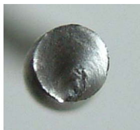
(d)針金の破壊面
