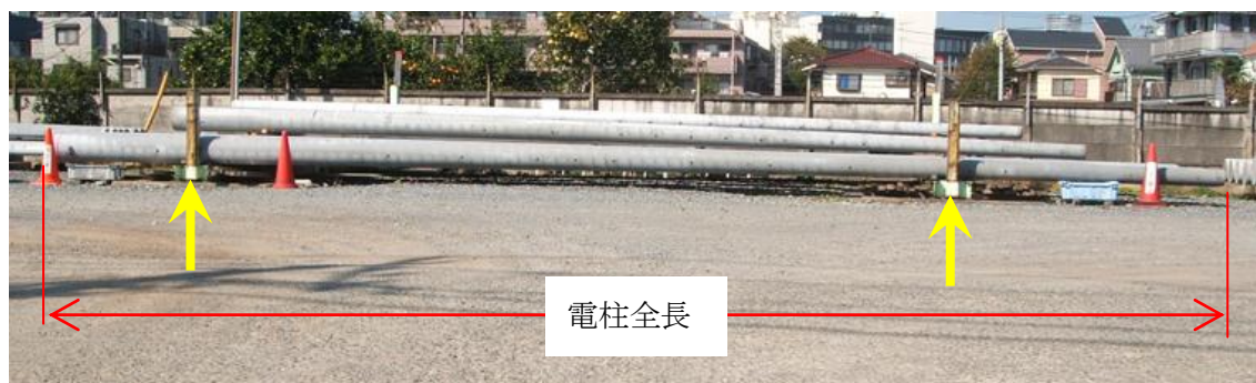
図 5 東京都市大学（武蔵工業大学から 2009 年 4 月 1 日名称変更）近くの電柱置き場にて見かけた電柱の支え方
